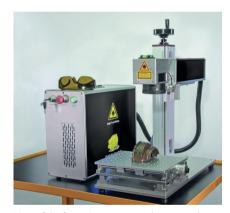
Verschiedene Lasertypen lassen sich parallel integrieren, sodass mit derselben Maschine etwa Metalle angelassen oder abgetragen und Kunststoffe aufgeschäumt werden können © Botzian & Kirch
